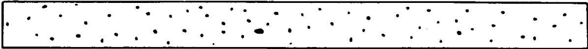
CANTIDAD Y TAMAÑO TIPICOS PERMITIDOS EN UNA LONGITUD DE SOLDADURA DE 6 PULG. DE MAS DE 1/4 PULG. HASTA 1/2 PULG. DE ESPESOR
