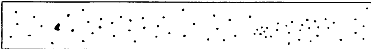
CANTIDAD Y TAMAÑO TIPICOS PERMITIDOS EN UNA LONGITUD DE SOLDADURA DE 6 PULG. DE MAS DE 1 PULG. DE ESPESOR
