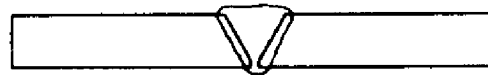
QW-463.1(b) PLACAS — ESESOR DE 3/4 PULG. Y MAS Y ALTERNAS DESDE 3/8 PULG. PERO MENOS DE 3/4 PULG. DE ESPESOR CALIFICACION DE PROCEDIMIENTO
