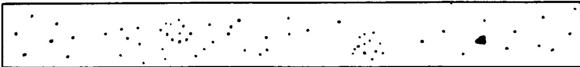
CANTIDAD Y TAMAÑO TIPICOS PERMITIDOS EN UNA LONGITUD DE SOLDADURA DE 6 PULG. DE MAS DE 1/2 PULG. HASTA 1 PULG. DE ESPESOR
