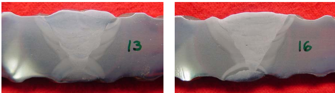
Fig. 5: Macrografía de las dos muestras evaluadas para posición 1G
