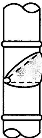
Fig.2: Disposición de la junta directa a tope en posición 3G
