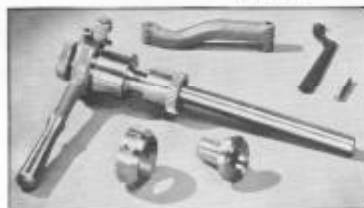
Fig. 169. Adaptador de mandril de boquillas con barra tractora de palanca a mano
