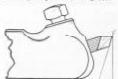
Fig. 214. Vista lateral de la cuchilla para filetear conformada para abrir roscas
