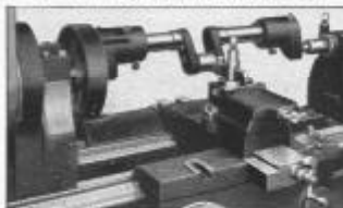
Fig. 335. Cigüeñal montado en el torno para trabajar el cojinete de la biela.
