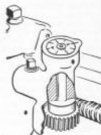
Fig. 237. Indicador de carátula para filetear colocado en el carro del torno
