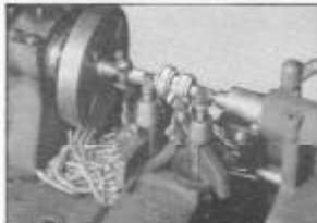
Fig. 295. Dos cuchillas cortando simultáneamente una pieza en trabajo
