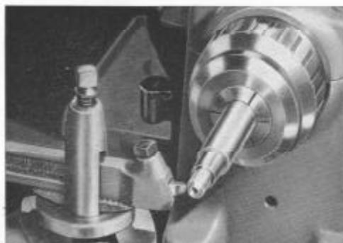
Fig. 161. Pieza en trabajo sostenida en mandril de boquillas con barra tractora
