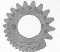
Fig. 216. Escantillón patrón para conformar cuchillas de filetear
