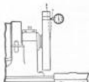
Fig. 106. Prueba de conexividad del plato con indicador de carátula
