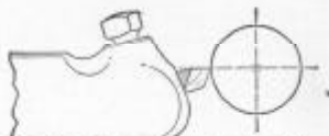
Fig. 217. Parte superior de la cuchilla colocada en el centro para abrir roscas
