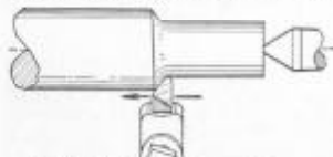
Fig. 69. Aplicación de la cuchilla para tornearse en la derecha
