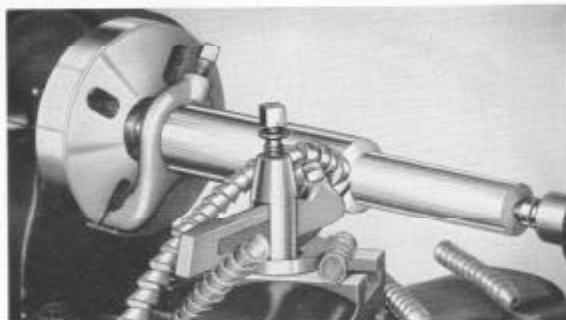
Fig. 113. Tornado de un árbol de acero montado entre las puntas
