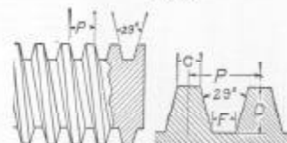
Fig. 245. Forma del filete de 29 grados para tornillo sinfin
