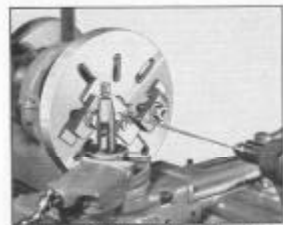
Fig. 263. Centrado de la pieza sobre el plato con un indicador de centros
