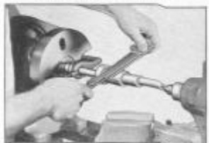
Fig. 266. Pulimento con tela de esmeril y aceite
