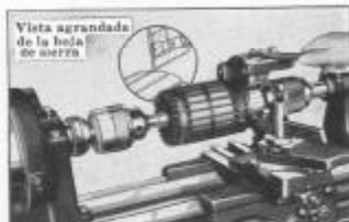
Fig. 330. Ranurado de un conmutador de inducido en el torno
