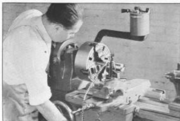
Fig. 148. Torneado de un árbol en un mandril con mordazas independientes
