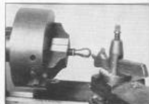
Fig. 296. Pieza de forma irregular sostenida por un mandril de dos mordazas
