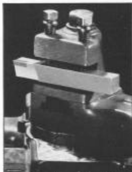
Fig. 88. Cuchilla con calza de tungsteno carburado montada en un poste para herramientas con lado abierto para apurte rígido
