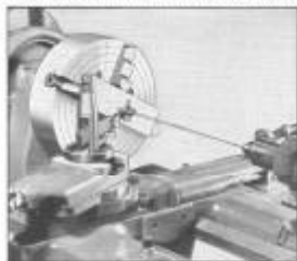
Fig. 153. Centrado por medio del indicador de centros
