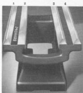
Fig. 20. Extremo de bancada, mostrando las guías prismáticas en "V"
