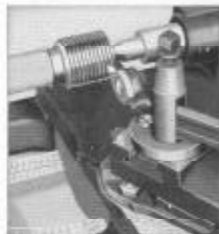
Fig. 222. Fileteado con el soporte compuesto colocado a un ángulo de 29 grados
