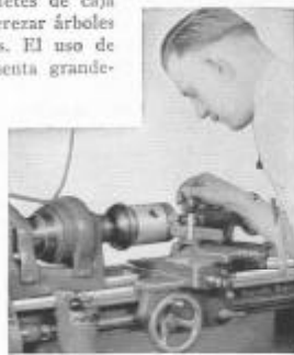
Fig. 329. Acabado de un émbolo en un torno de 229 mm
