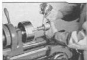
Fig. 267. Asentado del interior de un buje de acero endurecido con un dispositivo pulidor usando polvo de esmeril y aceite
