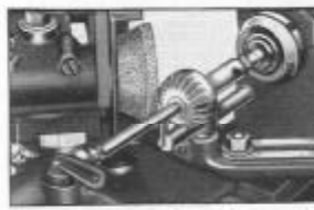
Fig. 321. Esmerilado de una fresa angular en el torno
