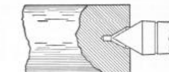
Fig. 128. Un agujero central incorrecto. Demasiado profundo para ajustarse a la punta del torno.
