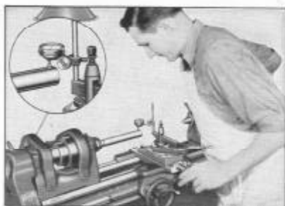
Fig. 104. Prueba del husillo del cabezal con barra patrón e indicador
