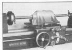
Fig. 277. Taladrado sobre el carro del torno
