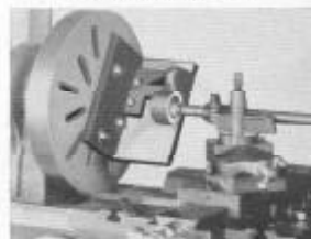
Fig. 262. Tornado interior de una abrazadera con una placa en "L" montada en el plato del torno
