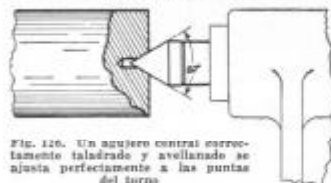
Fig. 125. Taladrado del agujero central con la pieza sostenida en el mandril del torno y la broca en el de la contrapunta.
