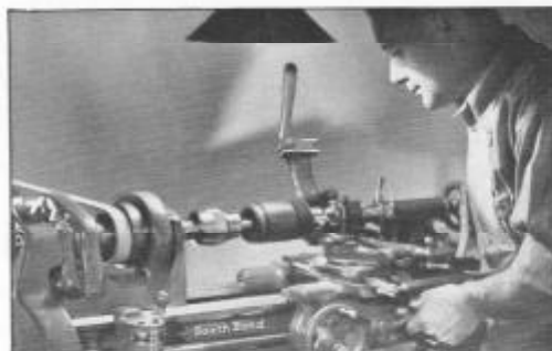
Fig. 327. Rectificación y ranurado de un conmutador de inducción en el torno
