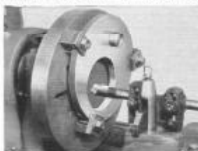
Fig. 261. Hechura de un agujero excéntrico sobre el plato del torno
